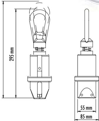
La pince Skuba, est dotée d'un dispositif de blocage automatique et ne rend pas nécessaire la fixation à l'aide de vis sur la tôle de la carrosserie. Les mâchoires moletées, en acier tempéré traité contre l'usure, peuvent être changées.
